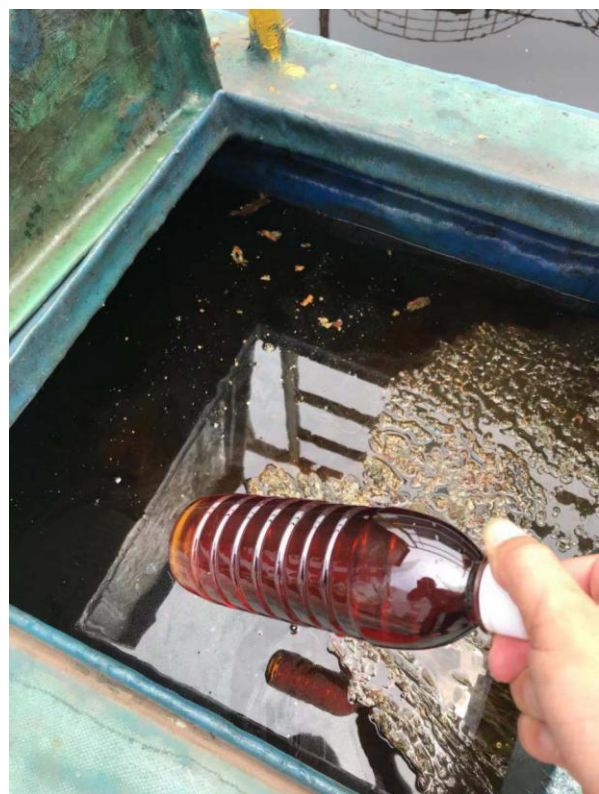
废水采样进口
