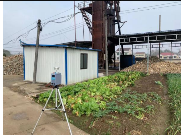
无组织废气采样照片 3
