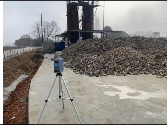
无组织废气采样照片 1
